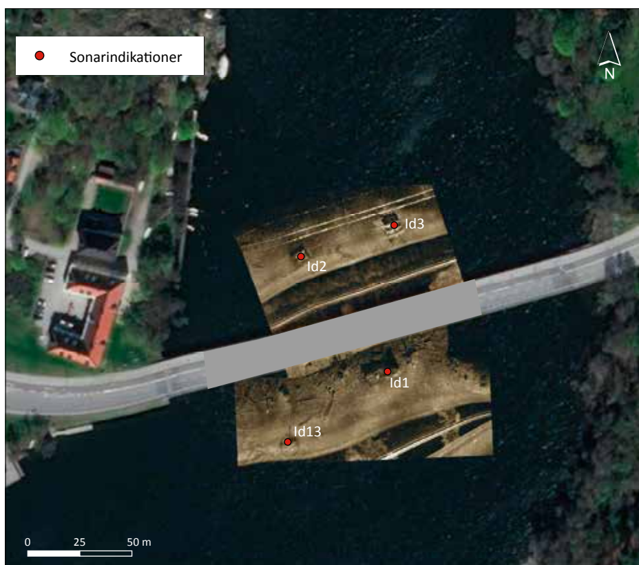
Fig. 15. Ortofoto som visar Drottningholmsbron med montage av side scan sonar mosaik som visar lämningarna som omtalas i rapporten. Källa: ESRI, bearbetad av Jens Lindström, NMG.
